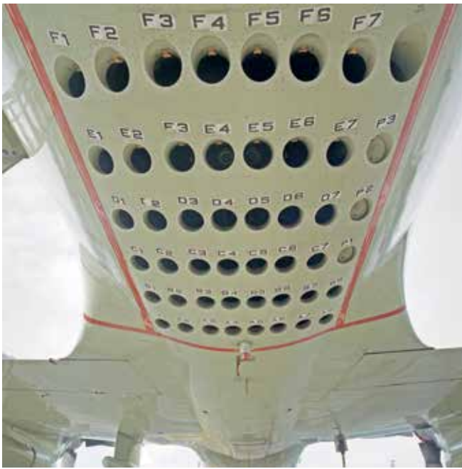
Onderzijde romp Nederlandse P-3C Orion met sonobuoy tubes (NIMH)
