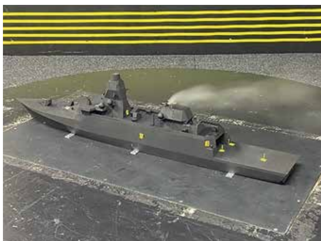
Afbeelding 5: windtunneltest van het ASWF
