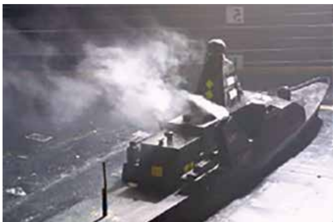
Afbeelding 2: windtunneltest van een OPV
