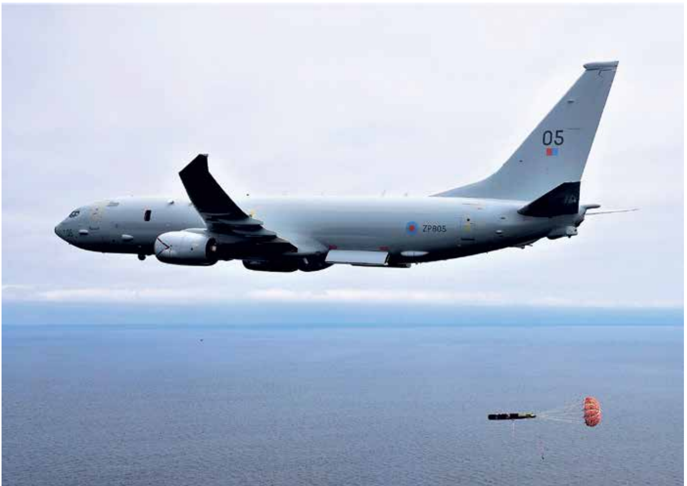
Een gloednieuwe Boeing P-8A Poseidon van de Royal Air Force oefent boven de baai van Moray met het lanceren van een Mark 54 torpedo, 22 juli 2021 (UK Ministry of Defence)
