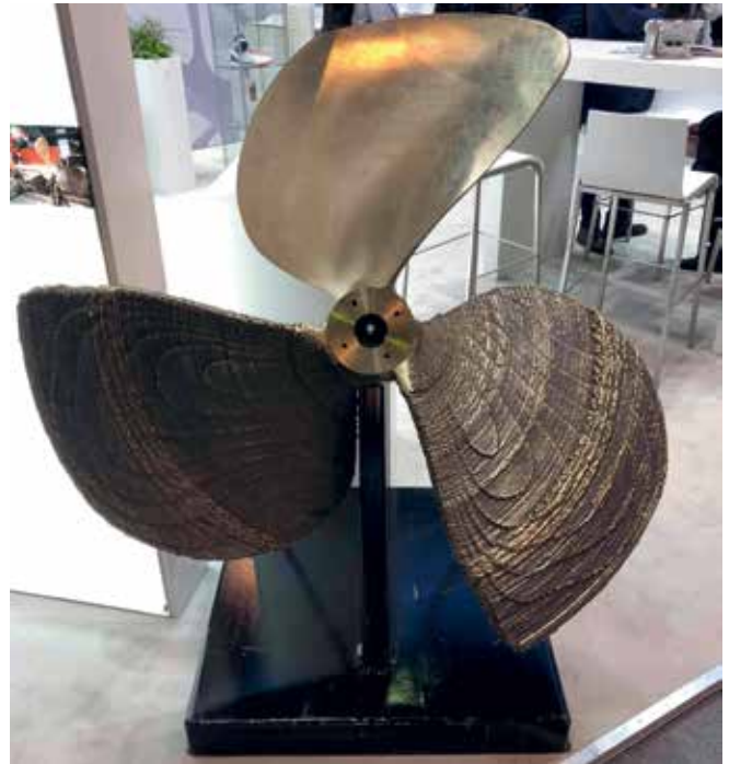
Een door RAMLAB voor Damen geprinte schroef die onder een sleepboot in de haven van Rotterdam is gebruikt (RAMLAB)
