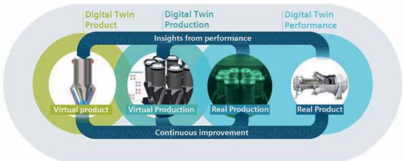
PDCA-cirkel tussen de digital twin van een product en de productie en het daadwerkelijke product en de prestaties hiervan (Siemens)
