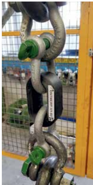
Vooruitgang en performance: kunststof geprinte hijschalm tilt 12 ton YPR-pantserwagen
